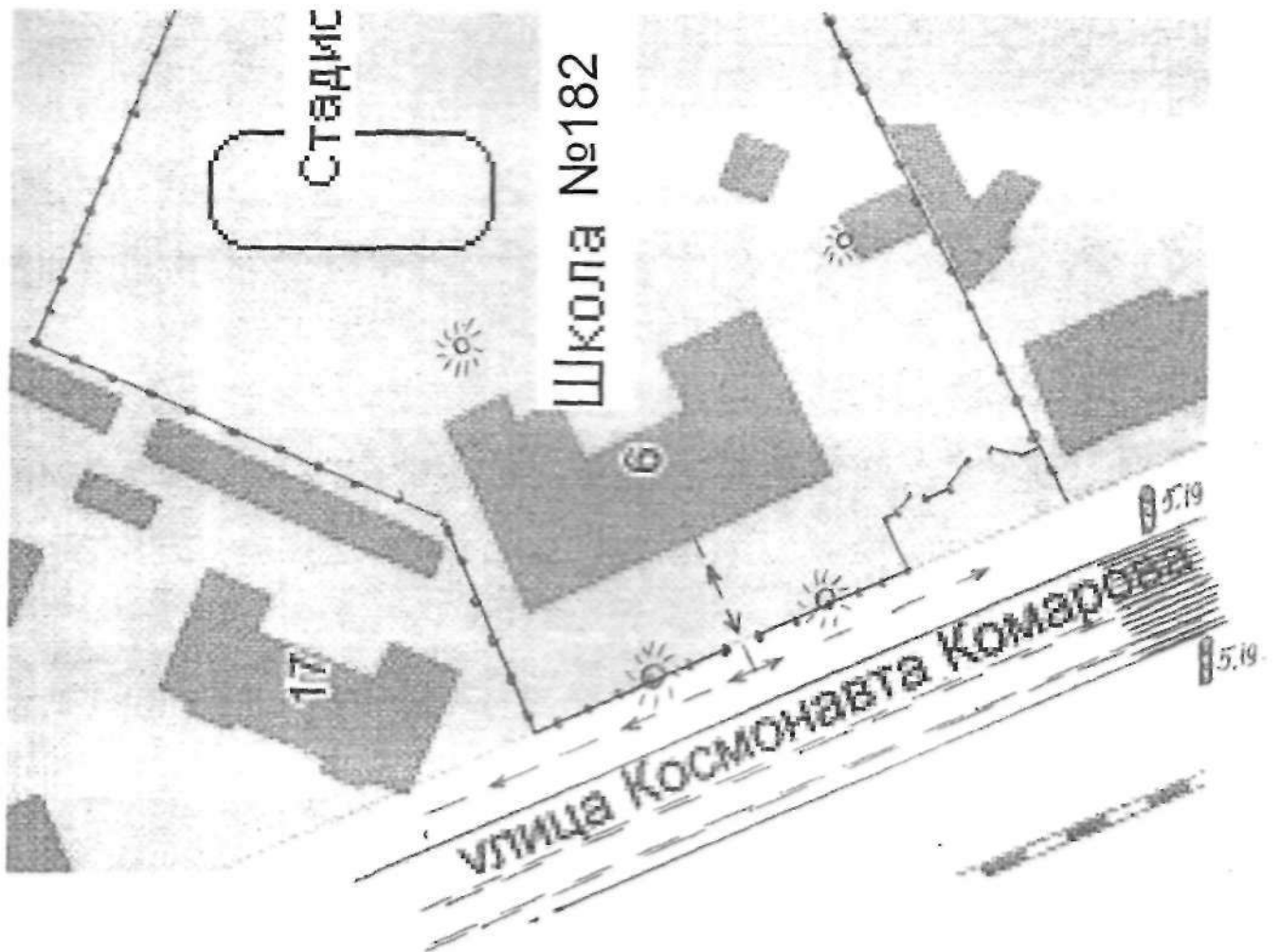
Схема организации дорожного движения в непосредственной близости от образовательного учреждения с размещением соответствующих технических средств, маршруты движения детей
